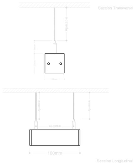
**ESPECIFICACIONES ELÉCTRICAS:****Voltaje/Tensión de Entrada:** 100-240V AC**Potencia:** 6W**Factor de Potencia:** 0.93**Atenuable:** No**OTRAS ESPECIFICACIONES TÉCNICAS:****Temperatura Ambiente:** -10°C ~ 40°C**Vida Útil:** 50000 Horas**Garantía:** 3 años
